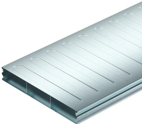
Unterflurkanal (2-teilig) zur Verlegung von Kabeln und Leitungen in estrichüberdeckten Unterflur-Systemen nach EN 50085-2-2. Abnehmbarer und durchgängig aufrastbarer Kanaldeckel. Mit Trennsteg im Kanalunterteil. Maximale Belastbarkeit bis 2kN.
