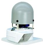
Ventilador centrífugo con simple aspiración de tejado fabricado en material plástico para trasegar gases corrosivos, con rodamiento de álabes hacia adelante directamente acoplado a eje motor F, IP55 y protector térmico incorporado, marca S&P modelo TMPB/6-20 0,18KW (230V50HZ) VE.
