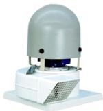
Ventilador centrífugo con simple aspiración de tejado fabricado en material plástico para trasegar gases corrosivos, con rodamiento de álabes hacia adelante directamente acoplado a eje motor F, IP55 y protector térmico incorporado, marca S&P modelo TM PB/4-20 0,18KW (230V50HZ) VE.
