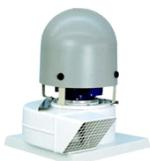
Ventilador centrífugo con simple aspiración de tejado fabricado en material plástico para trasegar gases corrosivos, con rodamiento de álabes hacia adelante directamente acoplado a eje motor F, IP55 y protector térmico incorporado, marca S&P modelo TMPT/2-14 0,18KW (230/400V50HZ) VE.
