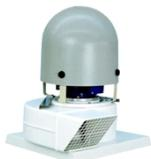
Ventilador centrífugo con simple aspiración de tejado fabricado en material plástico para trasegar gases corrosivos, con rodamiento de álabes hacia adelante directamente acoplado a eje motor F, IP55 y protector térmico incorporado, marca S&P modelo TMPB/4-14 0,18KW (230V50HZ) VE.
