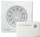
Ventiladores helicoidales de bajo nivel sonoro con luz, compuerta, temporizador 1-30min Y rodamiento a bolas, IP45, Clase II, con protector térmico y Sin Humidistato Electrónico, para trabajar a temperaturas de hasta 40°C, de color blanco para conectar a 230V.
