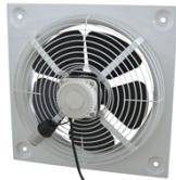
Ventiladores helicoidales murales de acero galvanizado, protegidos con pintura poliéster anticorrosiva, y motor monofásico 50/60Hz, de aluminio inyectado.
