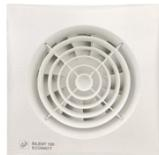
Ventiladores helicoidales de bajo nivel sonoro con luz, compuerta, temporizador 1-30min, detector de presencia y rodamiento a bolas, IP45, Clase II, con protector térmico y Sin Humidistato Electrónico, para trabajar a temperaturas de hasta 40°C, de color blanco para conectar a 230V.
