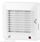
Ventiladores helicoidales con luz piloto, humidistato y cordel, IP30, clase II, con protector térmico, para trabajar a temperaturas de hasta 40°C.
