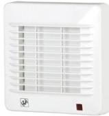
Ventiladores helicoidales con luz piloto, compuerta y temporizador 1-30min, IP44, clase II, con protector térmico, para trabajar a temperaturas de hasta 40°C.
