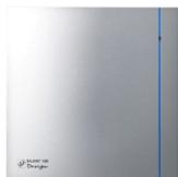
Ventiladores helicoidales de bajo nivel sonoro, luz, compuerta, temporizador 1-30min y rodamiento a bolas, IP45, clase II, con protector térmico, para trabajar a temperaturas de hasta 40°C, para conectar a 230V. Modelo en color plata con banda color Azul, Verde, Rojo y Amarillo.
