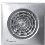
Ventiladores helicoidales de bajo nivel sonoro con luz piloto, compuerta y rodamiento a bolas, IP57, Clase III, con protector térmico y Sin Humidistato Electrónico, para trabajar a temperaturas de hasta 40°C, de color plata para conectar a 12V.
