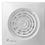
Ventiladores helicoidales de bajo nivel sonoro con luz piloto, compuerta, temporizador 1-30min y rodamiento a bolas, IP45, Clase II, con protector térmico, para trabajar a temperaturas de hasta 40°C, de color blanco para conectar a 230V.
