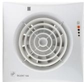
Ventiladores helicoidales de bajo nivel sonoro con luz piloto, compuerta, temporizador 1-30min, humidistato y rodamiento a bolas, IP45, Clase II, con protector térmico y Humidistato Electrónico, para trabajar a temperaturas de hasta 40°C, de color blanco para conectar a 230V.
