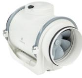
Ventilador helicocentrífugo in-line, de bajo perfil, para conductos circulares. Cuerpo motor ventilador desmontable, sin necesidad de manipular los conductos.
