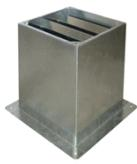
Soporte acústico para montar en ventiladores de tejado y atenuar el nivel sonoro en el interior del local. Montar en tejados horizontales. Se suministra la tornillería y una junta de goma para la estanqueidad.
