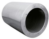
Silenciadores de chapa galvanizada Z200, de 0,8 mm de espesor (hasta el modelo 1250) ó 1,2 mm (modelo 1400), y brida de montaje con tuercas insertadas. Material fonoabsorbante en lana de roca de 70 kg/m<sup>3</sup> de densidad, con velo de protección contra el arrastre de partículas, y resistencia al fuego clase M0.
