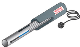
Монтаж ззовні водопровідної труби
