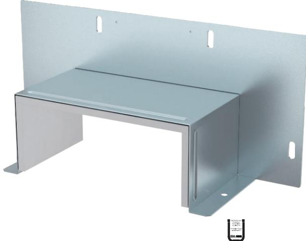
Rahmen als Zusatzisolation im Wandübergangsbereich bei direkter Wand- und Deckenmontage des BSKM 1025. Inklusive Blende und eingeklebter Dichtungen zum Abdichten der Fugen und loser Dichtung bei Kombination mit Gegenplatte, sowie Schraube für den Potentialausgleich.
