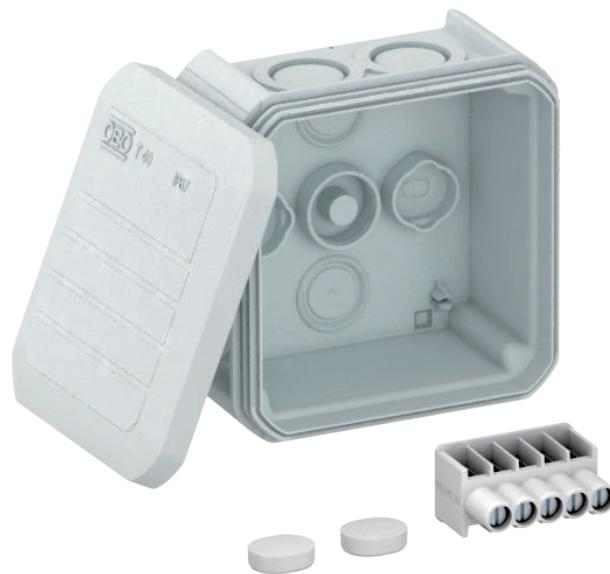
Kabelabzweigkasten zum Verbinden von Kabeln und Leitungen im Innenbereich und geschützten Außenbereichen. Quadratische Form mit Ausschlageinführungen an den Seiten und Ausschlageinführungen im Boden. Geeignet für die Wand-/ Deckenmontage und die Montage auf Montageblechen. Mit der Möglichkeit zur Innenbefestigung und Montage über die Eckdome. Mit fest sitzendem Klemmdeckel. Hergestellt aus halogenfreien Materialien.
