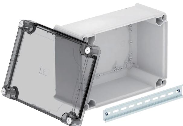
Kabelabzweigkasten geschlossen zum Verbinden von Kabeln und Leitungen im Innenbereich und geschützten Außenbereichen. Rechteckige Form ohne Einführungen. Geeignet für die Wand-/Deckenmontage, die Montage auf Montageblechen und Gewinde im Boden. Mit der Möglichkeit zur Innenbefestigung und Montage über die Eckdome. Hoher, transparenter Deckel mit Schnellverschluss, plombierbar. Hergestellt aus halogenfreien Materialien. Inklusive Huprofilschiene.
