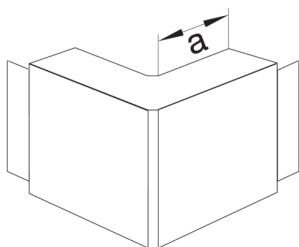
**Außeneck schnittkaschierend halogenfrei zu Kanalsystem LF/LFH 30x45mm reinweiß**
