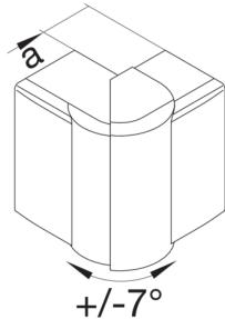
**Außeneck einstellbar schnittkaschierend halogenfrei zu LF/LFH 40x60mm reinweiß**
