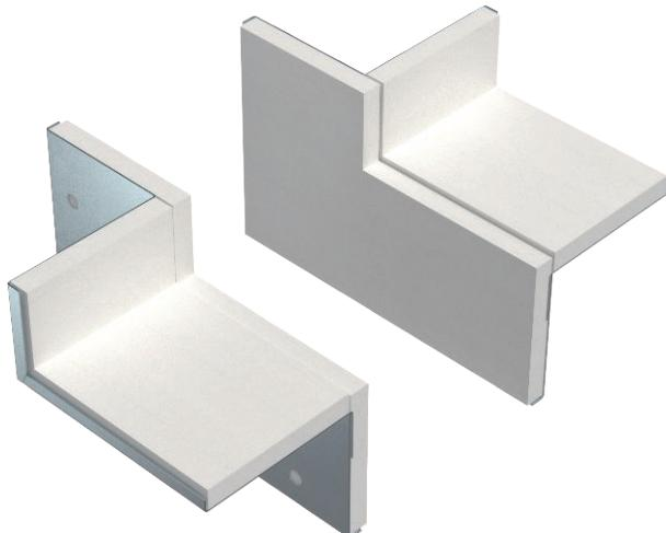
Wandanschlusskragen, 2-seitig mit integrierter Dichtung für Installationskanal PYROLINE® Rapid PLM. Zur Montage im Bereich von Wand- und Deckenanschlüssen sowie Wanddurchführungen in Raumecken. Set bestehend aus 2 entgegengesetzten Bauteilen, passend für Decken- oder Wandmontage des Installationskanals.
