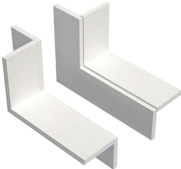
Wandanschlusskragen, 2-seitig mit integrierter Dichtung für Installationskanal PYROLINE® Rapid PLM. Zur Montage im Bereich von Wand- und Deckenanschlüssen sowie Wanddurchführungen in Raumecken. Set bestehend aus 2 entgegengesetzten Bauteilen, passend für Decken- oder Wandmontage des Installationskanals.
