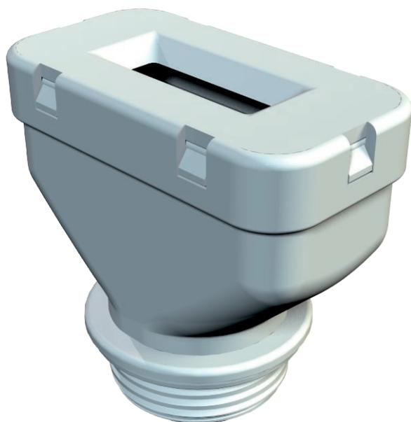
Flachkabeleinführung in Würgenippelbauart, mit metrischem Anschlussgewinde nach IEC 432, Schutzart IP31, mit vormontiertem Stützendichtring 107/F.
