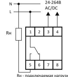
Схема подключения изделия и нагрузки, запитанных от разных источников.
