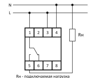
Схема подключения изделия и нагрузки к сети 230В.
